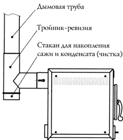
Рис. 4 – Схема присоединения Энергопечи к дымоходу.
