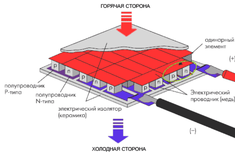
Рис. 2 – Устройство термоэлектрического модуля.
